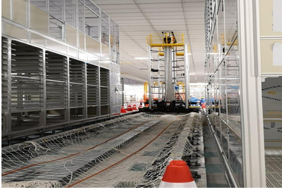
立体仓库，也叫自动化立体仓储，物流仓储中出现的新概念，利用立体仓库设备可实现仓库高层合理化，存取自动化，操作简便化：自动化立体仓库，是当前技术水平较高的仓储方式。自动化立体仓库的主体由货架，巷道式堆垛起重机、入（出）库工作台和自动运进（出）及操作控制系统组成。货架是钢结构或钢筋混凝土结构的建筑物或结构体，货架内是标准尺寸的货位空间，巷道堆垛起重机穿行于货架之间的巷道中，完成存、取货的工作。管理上采用计算机及条形码技术。立体仓库分类：分为托盘存储和箱式存储两种。1. 托盘存储多用于成品存储，分为堆垛机和穿梭板两种。2. 箱式存储用于生产环节和配送环节的拆零拣选，分为miniload（箱式堆垛机）和多层穿梭车两种。总的来说堆垛机式存储技术成熟稳定，穿梭式存储系统柔性高，具有可扩充性，并且单台设备出现故障不影响整体工作，缺点是货架精度要求高。
