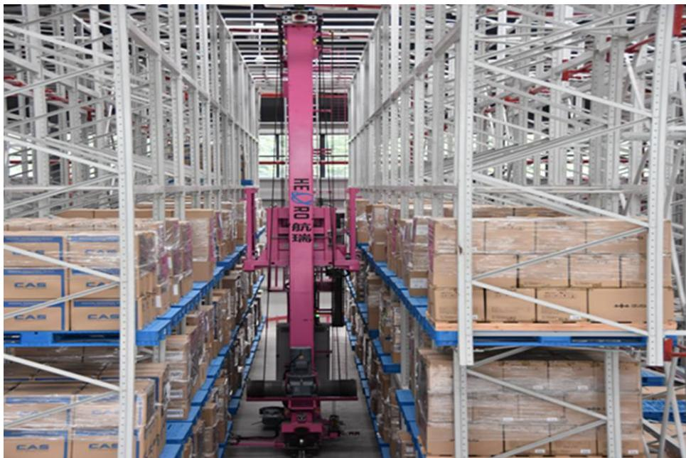
立体仓库，是利用自动化存储设备同计算机管理系统的协作来实现立体仓库的高层合理化，存取自动化，以及操作简便化。自动化立体仓库的主要由货架，巷道式堆垛起重机（堆垛机）、入（出）库工作站、调度控制系统以及管理系统组成。货架一般为钢结构或钢筋混凝土结构的结构体，货架内部空间作为货位存放位置，堆垛机穿行于货架之间的巷道中，可由入库站台取货并根据管理调度任务将货位存储到指定货位，或到指定货位取出货物并送至出库站台。它是以多层货架构成，通常是将物料存放在标准的料箱或托盘内。湛江立体仓库哪个牌子好
